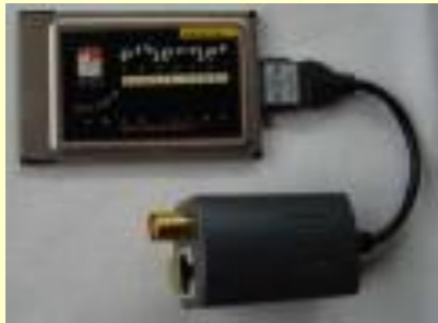
BNC-Anschluss (links) für Koaxial- und RJ45-Anschluss (rechts) für TP-Kabel
